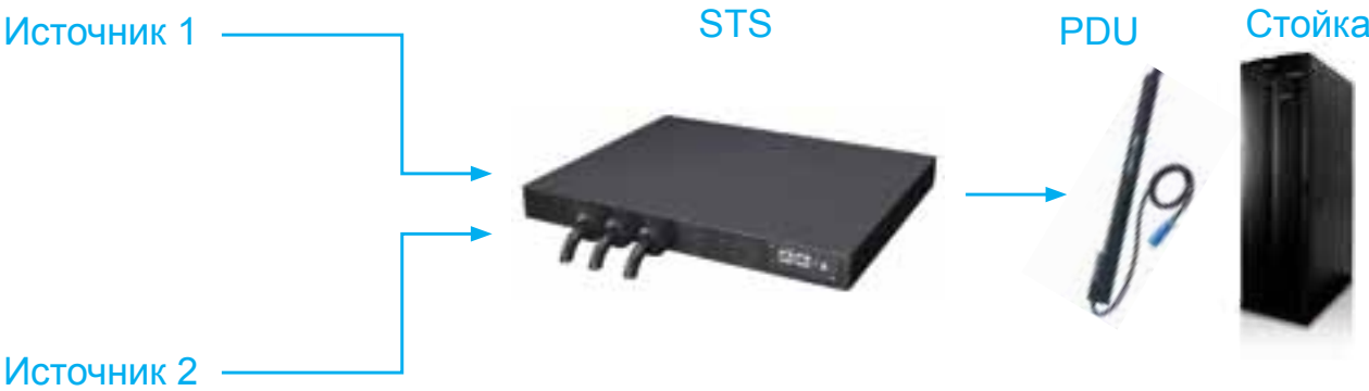
▲ Обеспечивает надёжное резервирование источников питания
